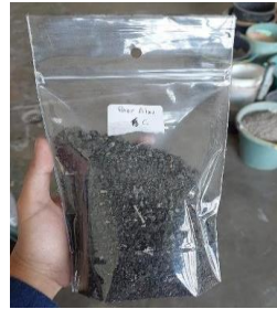
Gambar I. 10 Persiapan material Agregat residu abu sebagai pengganti pasir
