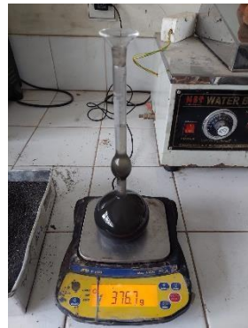
Gambar H. 8 Pengujian Berat Jenis Abu Insinerator
