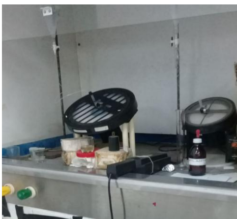
Permurnian dengan menggunakan kromatotron
