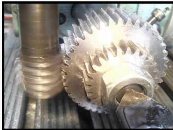
Gambar 24. Proses Frais Roda Gigi
