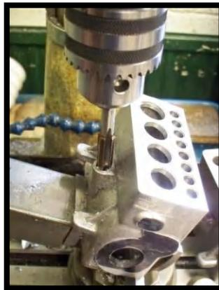
Gambar 21. Proses Kerja Frais Miring
