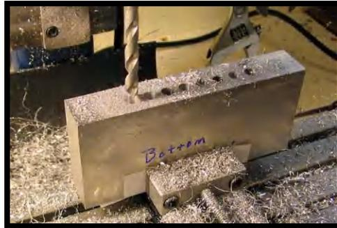
Gambar 22. Proses Pelubangan menggunakan mesin frais
