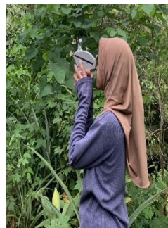
Mengukur tinggi dengan Hagameter
