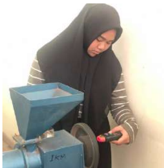
Gambar 16. Pengukuran rpm pada alat.
