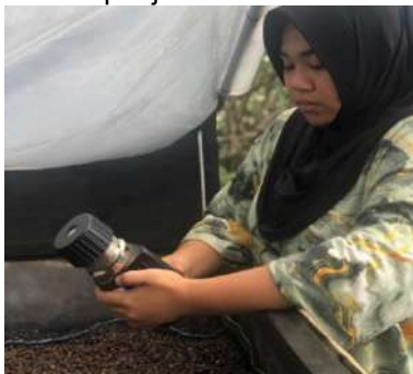
Gambar 11. Proses pengukuran kadar air setelah dijemur.
