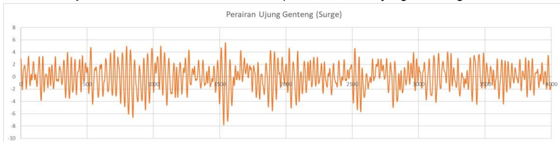
Lampiran 16. Grafik hasil running structure position surge, sway, heave, roll, pitch, dan yaw semi-submersible OC4 5MW pada Perairan Ujung Genteng
