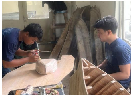
Gambar 30. Proses pemberian resin pada model Sumber: Proses pembuatan model
