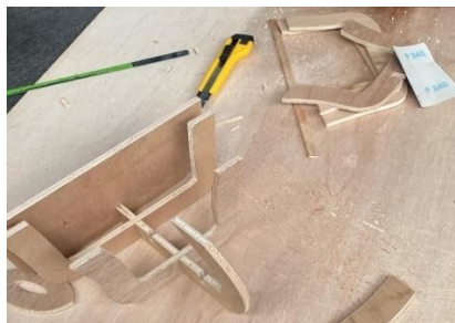
Gambar 28. Pemasangan frame pada lunas Sumber: Proses pembuatan model
