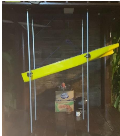
Gambar 34. Proses pemasangan kapal pada rel
