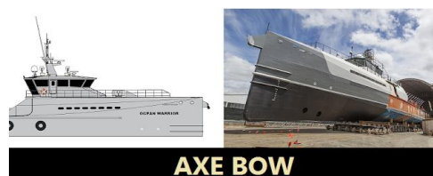
Gambar 7. Haluan kapal axe bow Sumber: Ilmu kapal dan logistik,2023
