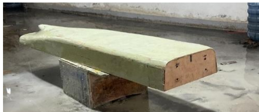
Gambar 31. Proses pemberian dempul pada model Sumber: Proses pembuatan model
