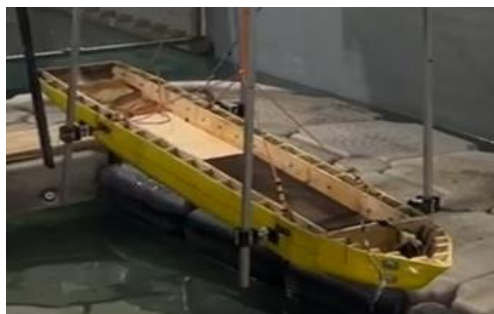
Gambar 40. Pemasangan model pada rel yang akan di uji Sumber: Proses pengujian model
