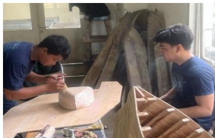
Gambar 30. Proses Pemberian Resin Pada Model Kapal Sumber: Proses pembuatan model
