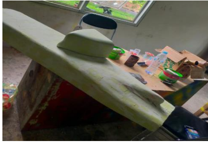
Gambar 31. Proses Pemberian Dempul Pada Mode Kapal Sumber: Proses pembuatan model
