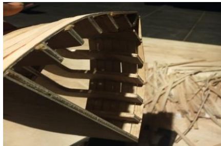
Gambar 29. Pemasangan Kulit pada Frame Sumber: Proses pembuatan model
