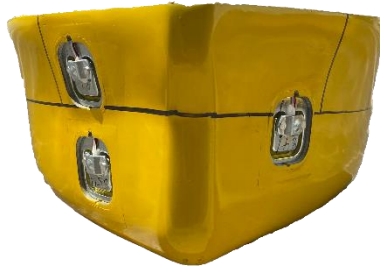
Gambar 41. Peletakan Sensor Loadcell Sumber: Prosedur pengujian model
