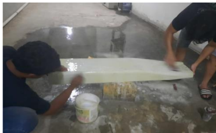
Gambar 32. Proses Pengampalasan pada Model Sumber: Proses pembuatan model
