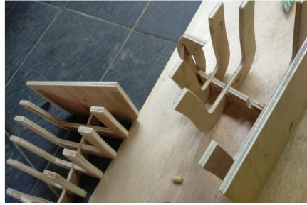
Gambar 28. Pemasangan Frame pada Lunas Sumber: Proses pembuatan model
