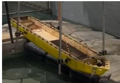
Gambar 42. Pemasangan model pada rel yang akan diuji Sumber: Prosedur pengujian model
