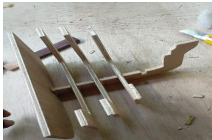
Gambar 27. Pemasangan Frame pada lunas
