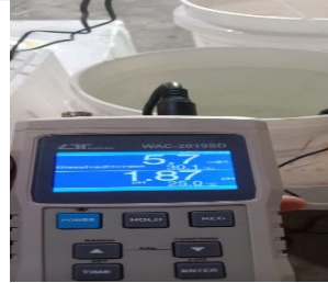
Monitoring oksigen terlarut
