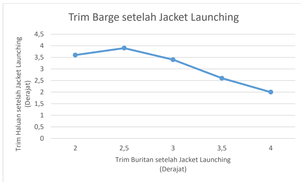
Gambar 4.31 Derajat Trim Haluan setelah Jacket Launching
