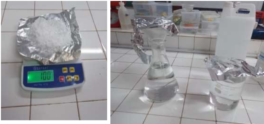
Proses pencampuran larutan KOH 20%
