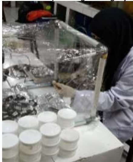
Proses filtrasi mikroplastik menggunakan pompa vakum
