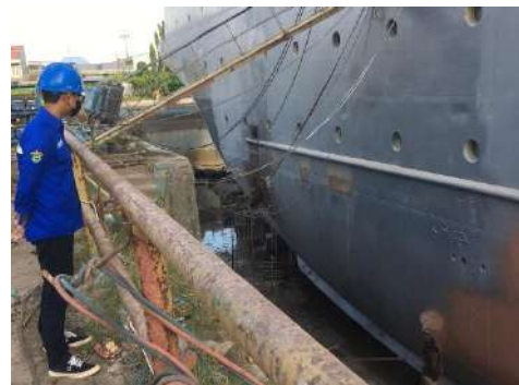
Pengamatan proses pengecatan lapisan akhir AF ( Anti fouling )
