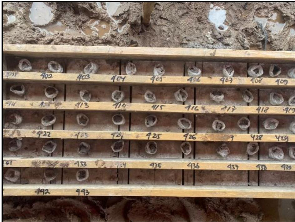
**Gambar 2.10** Contoh *core box* metode *touch core* pada *drill hole* OPT C2-22-02C.
