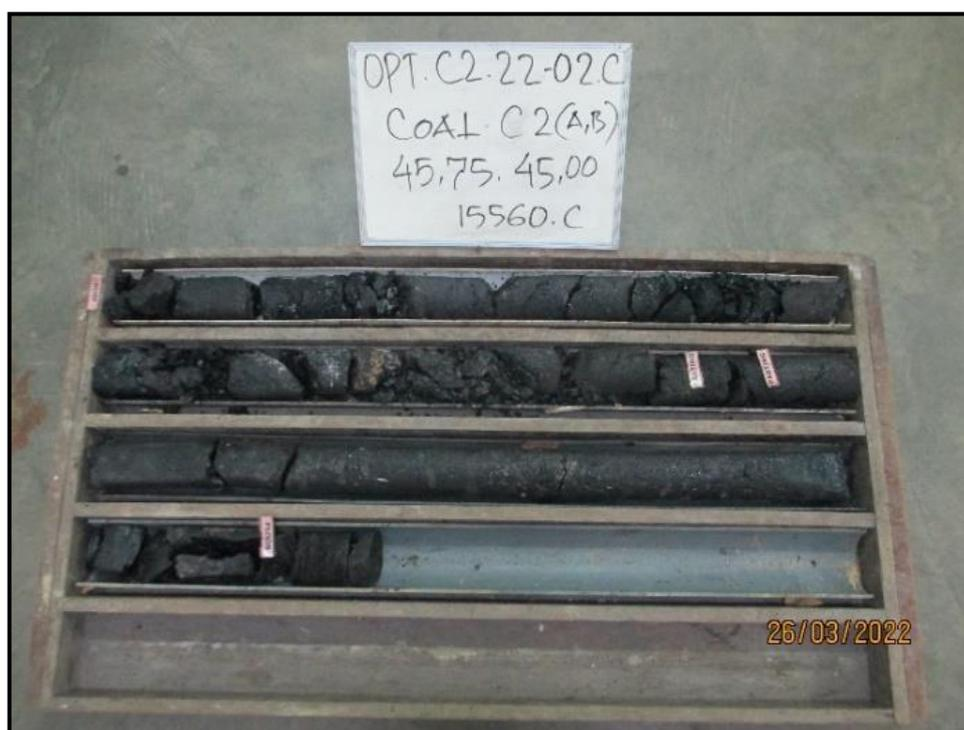
**Gambar 2.9** Contoh *core box* metode *full core* pada *drill hole* OPT C2-22-02C.
