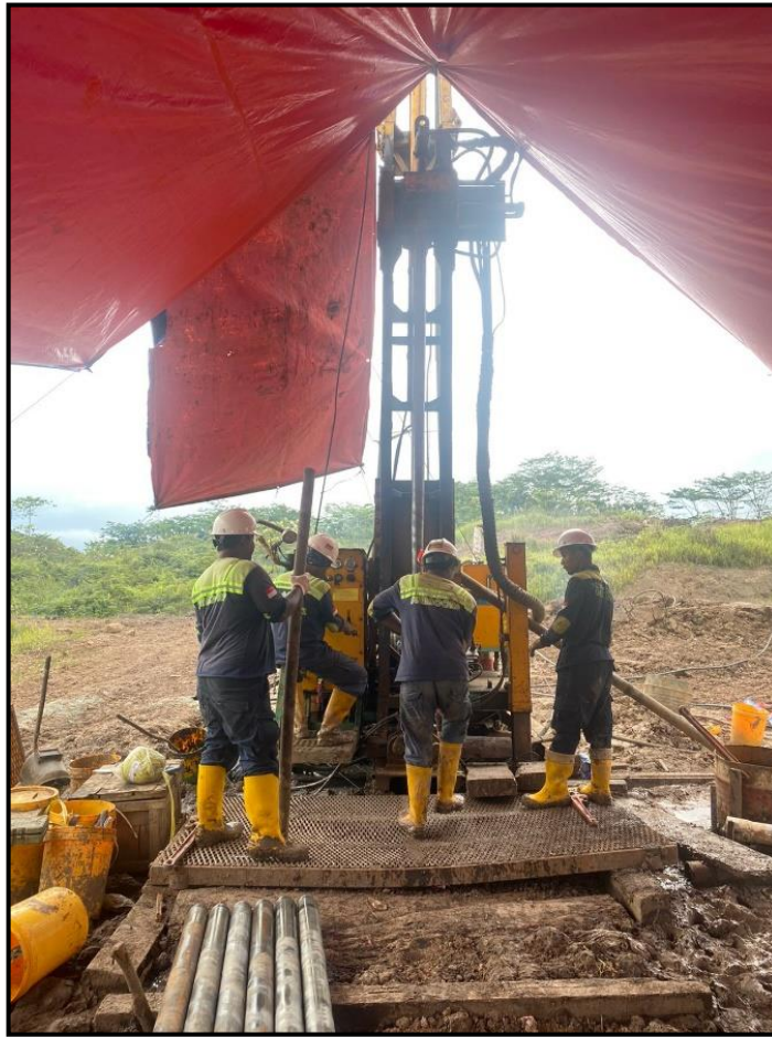
Gambar 2.8 Kegiatan Pengeboran dengan metode open hole , full core , dan touch core oleh tim Dando PT. IMM
