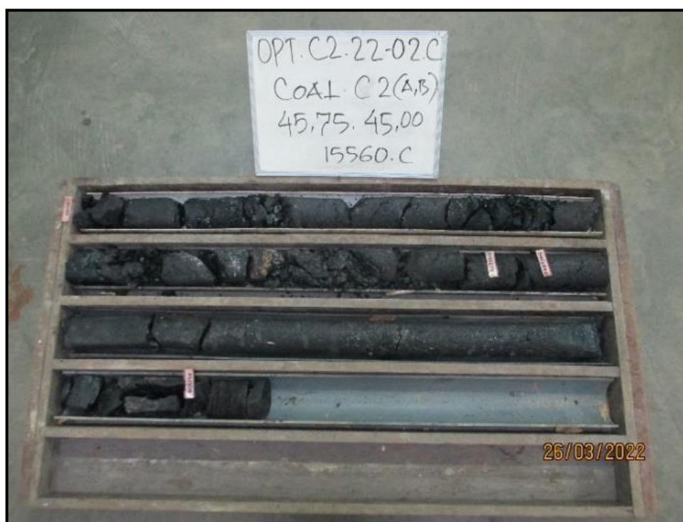
Gambar 2.9 Contoh core box metode full core pada drill hole OPT C2-22-02C.
