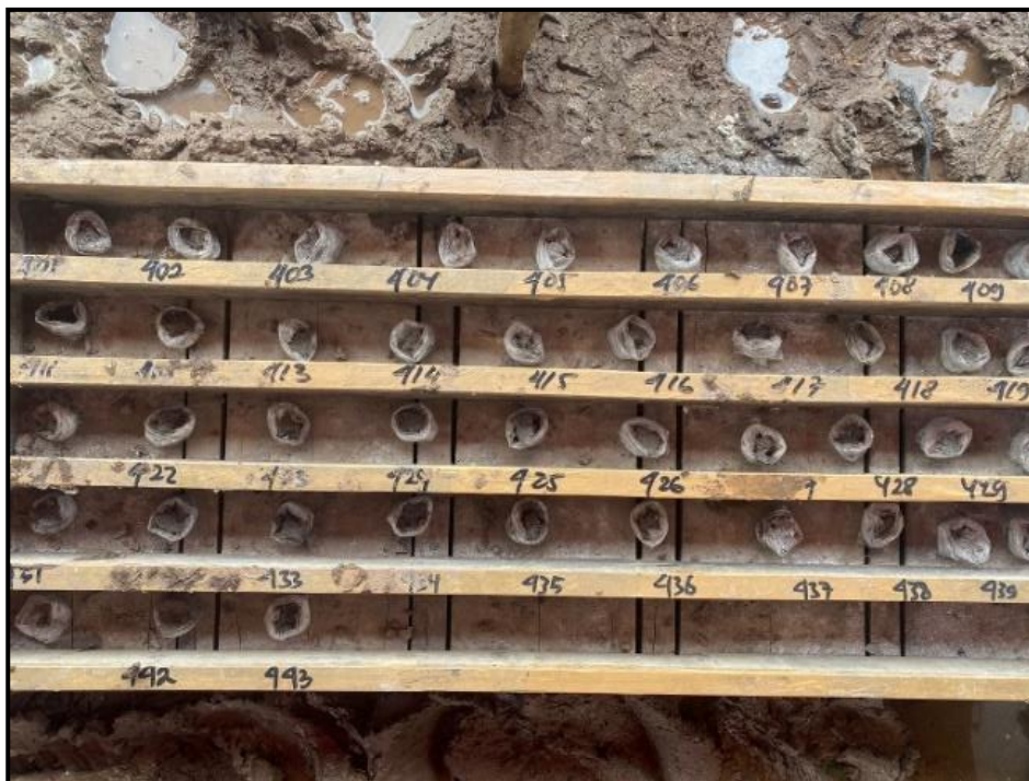
Gambar 2.10 Contoh core box metode touch core pada drill hole OPT C2-22-02C.
