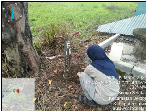
a) Pengukuran laju infiltrasi
