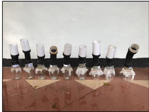
a) Pengukuran permeabilitas tanah
