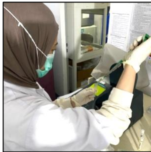
Pengukuran nilai OD bakteri V. parahaemolyticus menggunakan spektrofotometer
