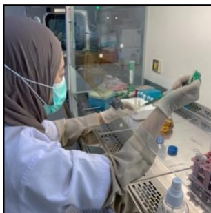
Pengukuran nilai OD bakteri V. parahaemolyticus menggunakan spektrofotometer
