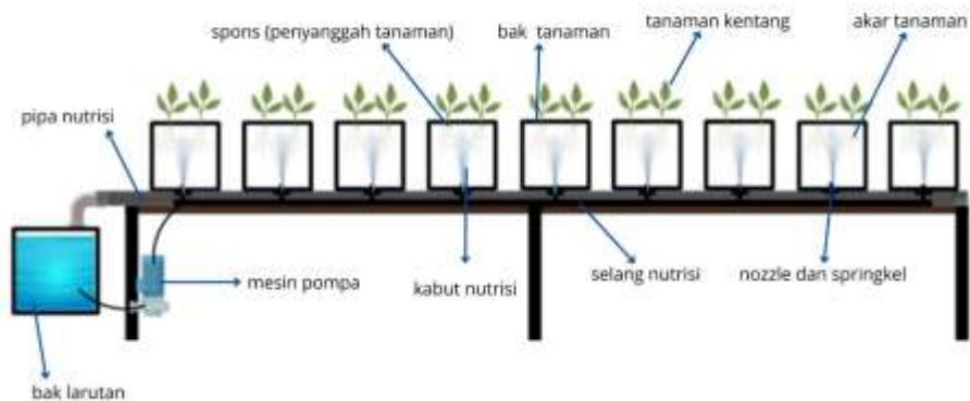
Gambar 1. Instalasi aeroponik tanaman kentang
