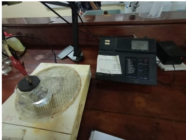
Pengukuran potensial menggunakan elektroda pasta karbon MIP
