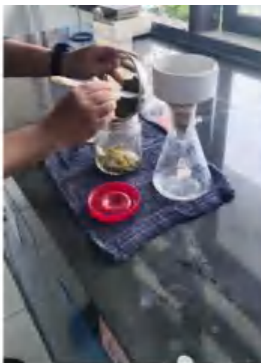
Penyaringan dengan corong bunchner
