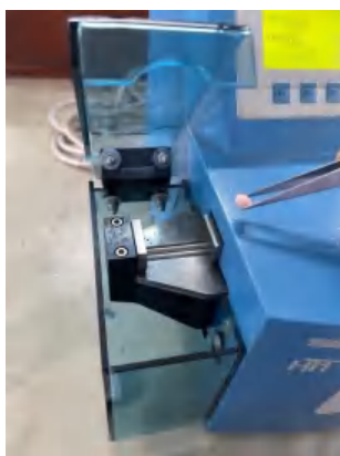
Gambar 10. Uji kekerasan tablet dengan alat hardness tester
