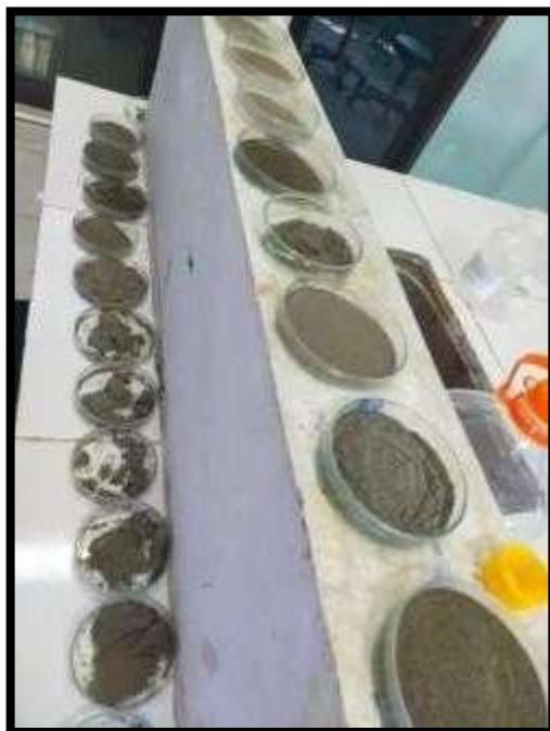
Penggerusan Sampel Sedimen Sebelum Analisis Logam
