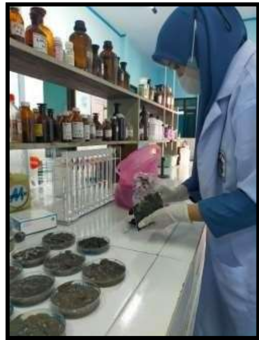
Persiapan Sampel Sedimen Untuk Analisis Logam
