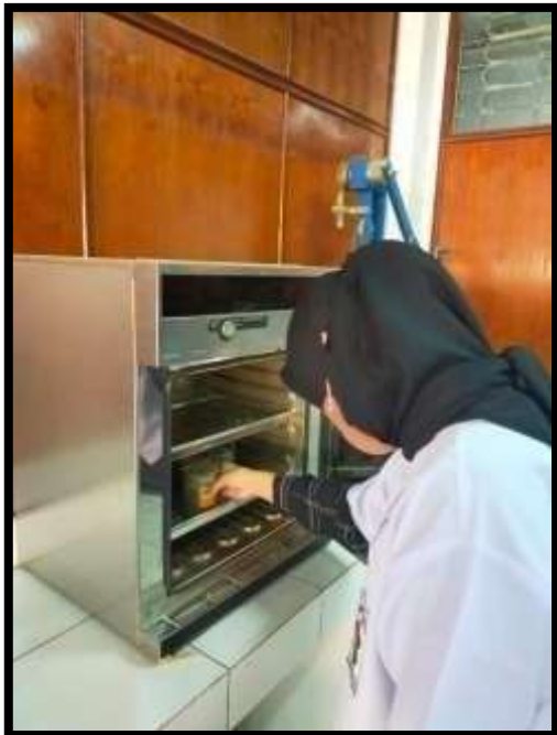
Pengeringan Sampel Sedimen Menggunakan Oven
