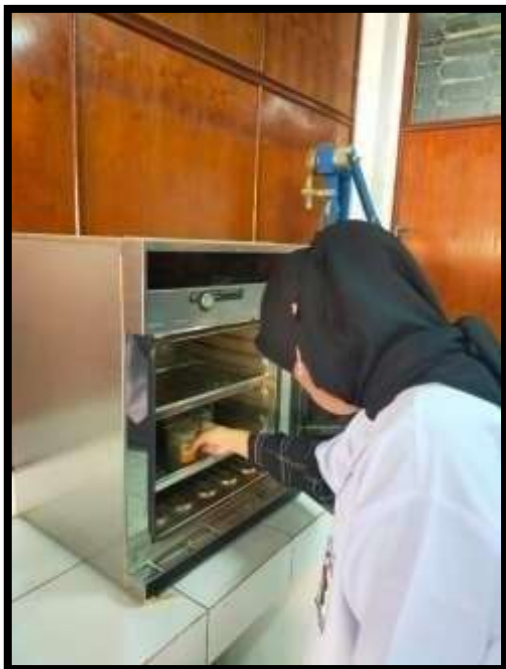
Pengeringan Sampel Sedimen Menggunakan Oven
