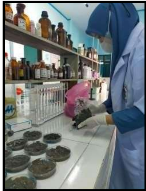
Persiapan Sampel Sedimen Untuk Analisis Logam
