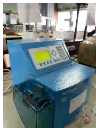
Gambar 12. Pengukuran uji kekerasan tablet kaptopril
