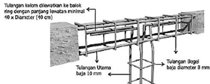
Gambar 25. Hubungan antara kolom dengan balok keliling/ringbalk
