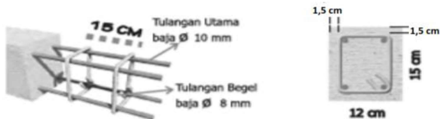
Gambar 4 Dimensi tulangan balok keliling/ringbalk
