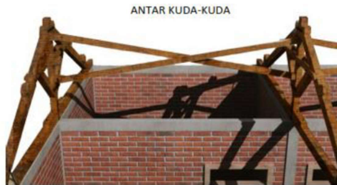
Gambar 11. Ikatan angin sebagai pengikat antar kuda-kuda kayu
