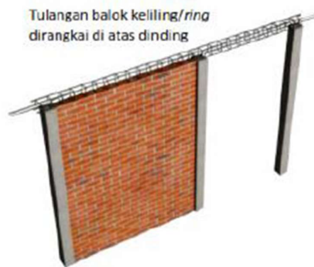
Gambar 31. Perangkaian tulangan balok keliling /ring di atas dinding
