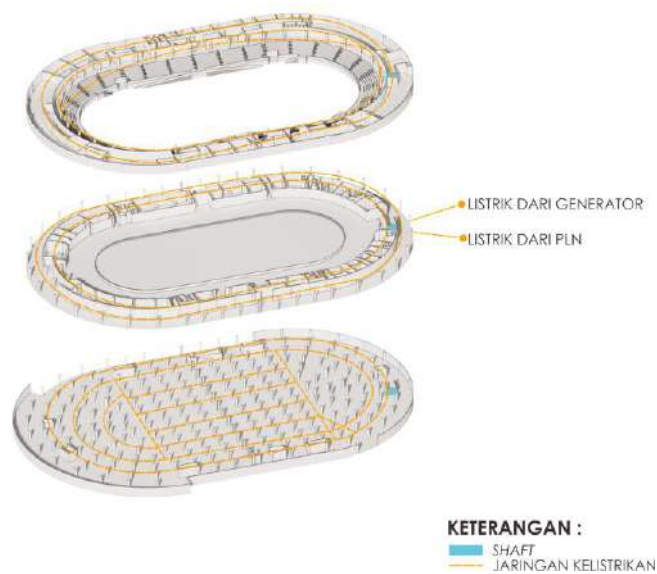
Gambar 12 Isometri mekanikal elektrik
