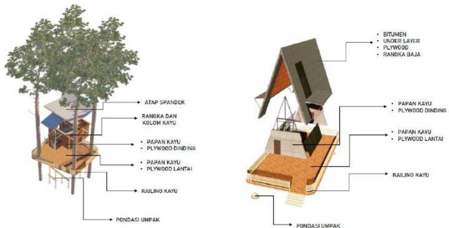
Gambar 2.5 Konsep Sistem Struktur
