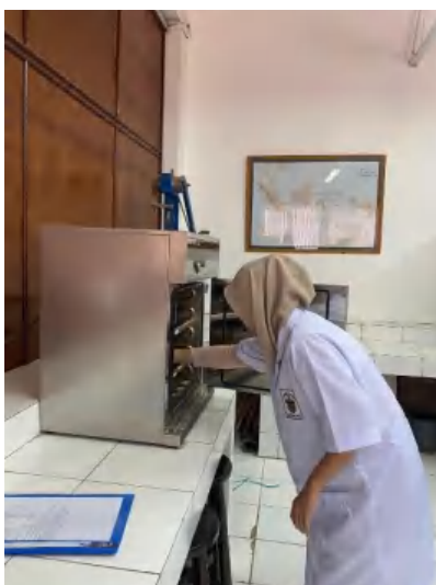
Pengeringan Sampel Sediemen Menggunakan Oven
