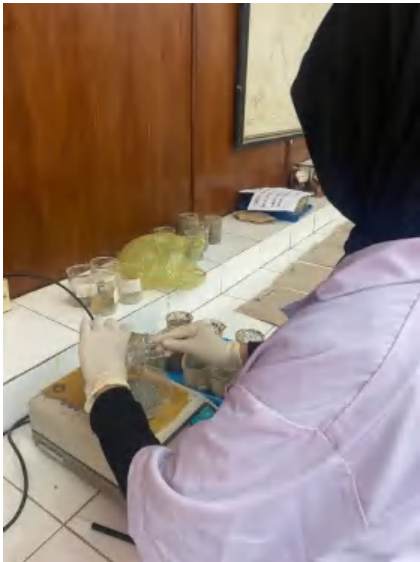
Menimbang Sampel Sedimen
