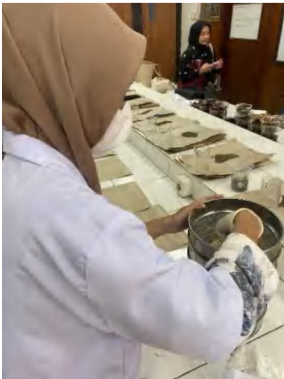
Proses Pengayakan Sampel Sedimen
