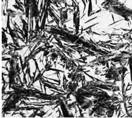
Gambar 2.26 Mikrostruktura martensit : lembaran tipis warna hitam adalah martensit, sedangkan yang berwarna putih adalah austenite sisa (William D, 7 e).
