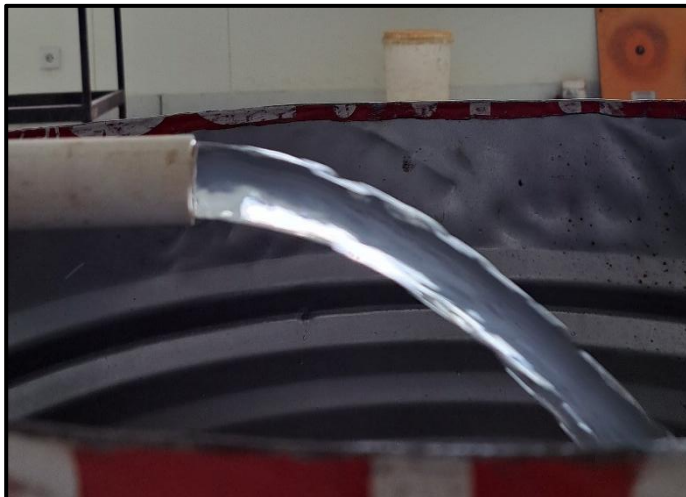
Gambar 50 Gambar aliran pembukaan katup 90° pada pipa pvc
