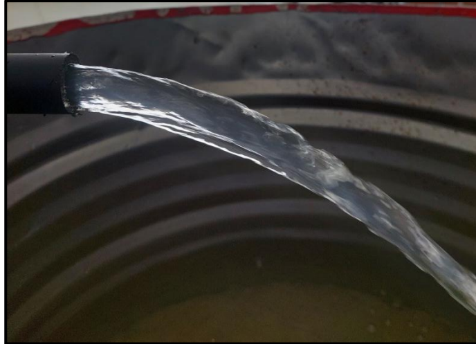
Gambar 53 Gambar aliran pembukaan katup 70° pada pipa HDPE
