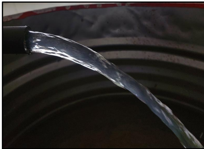
Gambar 52 Gambar aliran pembukaan katup 60° pada pipa HDPE
