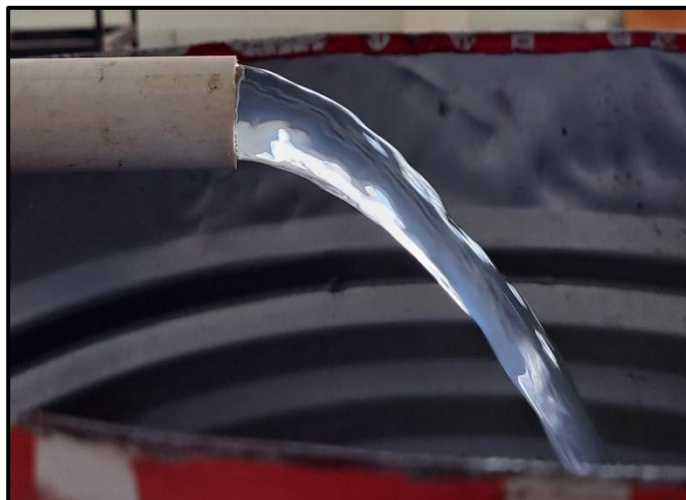
Gambar 47 Gambar aliran pembukaan katup 60° pada pipa pvc
