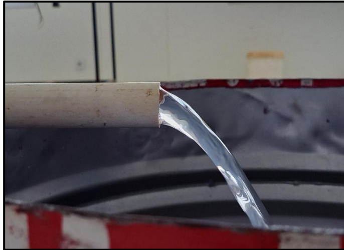
Gambar 46 Gambar aliran pembukaan katup 50° pada pipa pvc
