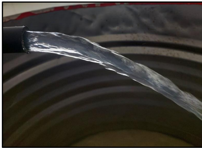
Gambar 55 Gambar aliran pembukaan katup 90° pada pipa HDPE
