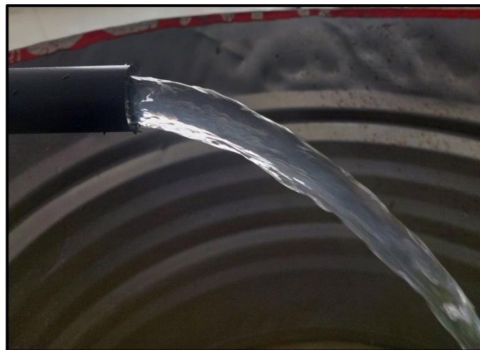
Gambar 51 Gambar aliran pembukaan katup 50° pada pipa HDPE
