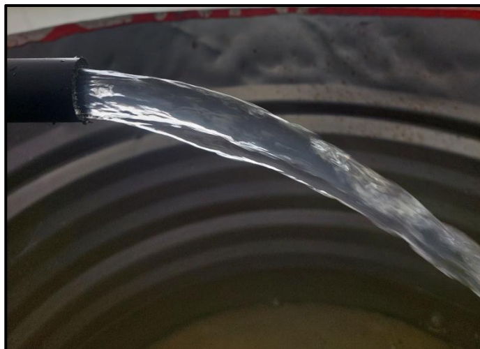
Gambar 54 Gambar aliran pembukaan katup 80° pada pipa HDPE
