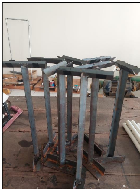
Gambar 9 Pipe supports (penyangga pipa)
