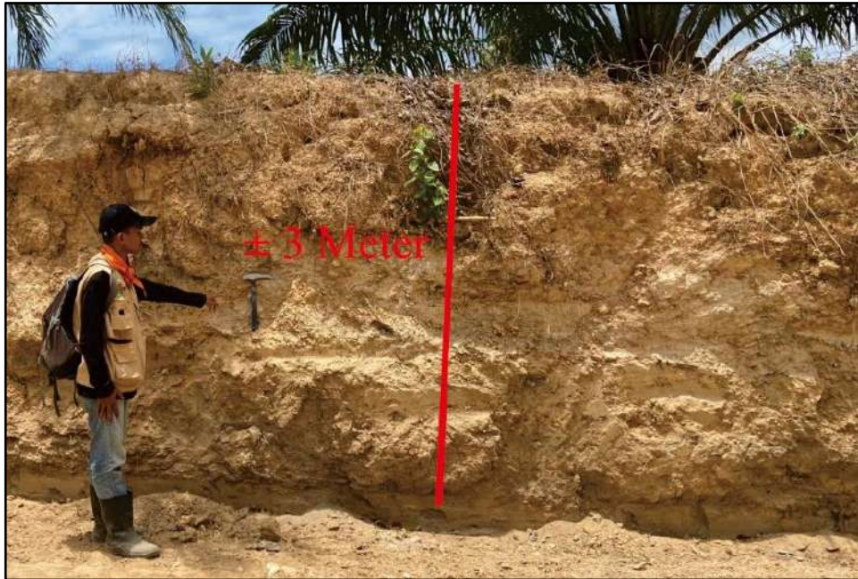
Gambar 15 Kenampakan residual soil dengan ketebalan \pm 2 meter pada litologi batupasir yang dijumpai pada daerah Eewa. Difoto ke arah N322°E
