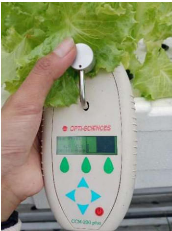
Gambar.8 Pengukuran indeks klorofil daun
