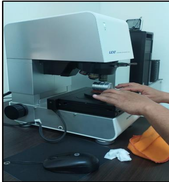
Penempatan spesimen pada meja alat Olympus
