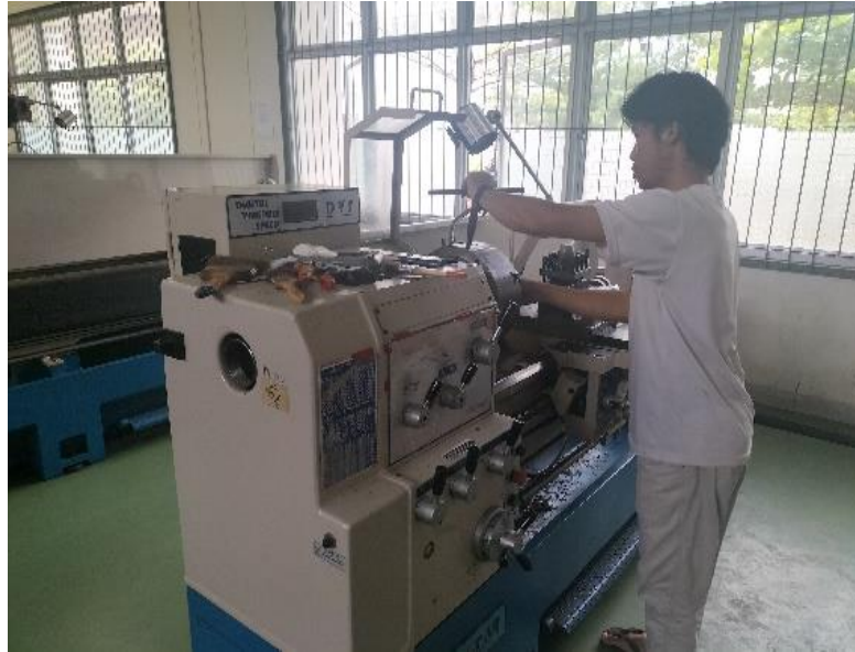
Memasang benda kerja pada Chuck
