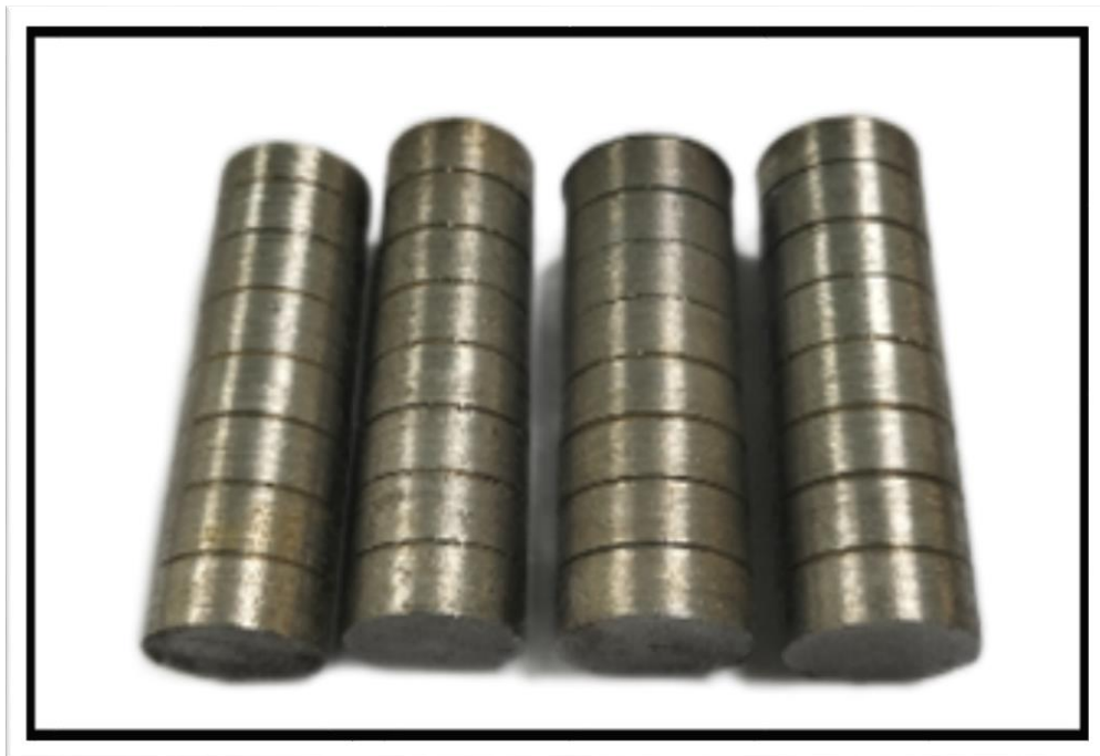
Hasil pembubutan material baja AISI 1045
