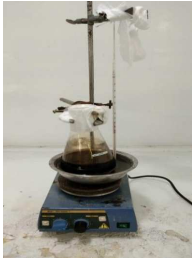
Modifikasi Karbon Aktif Tempurung Kemiri dengan Larutan HNO 3 6 N
