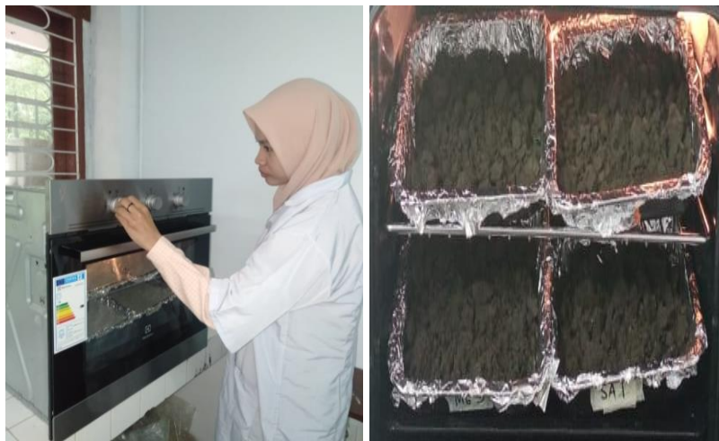
Proses pengeringan sampel sedimen dengan oven
