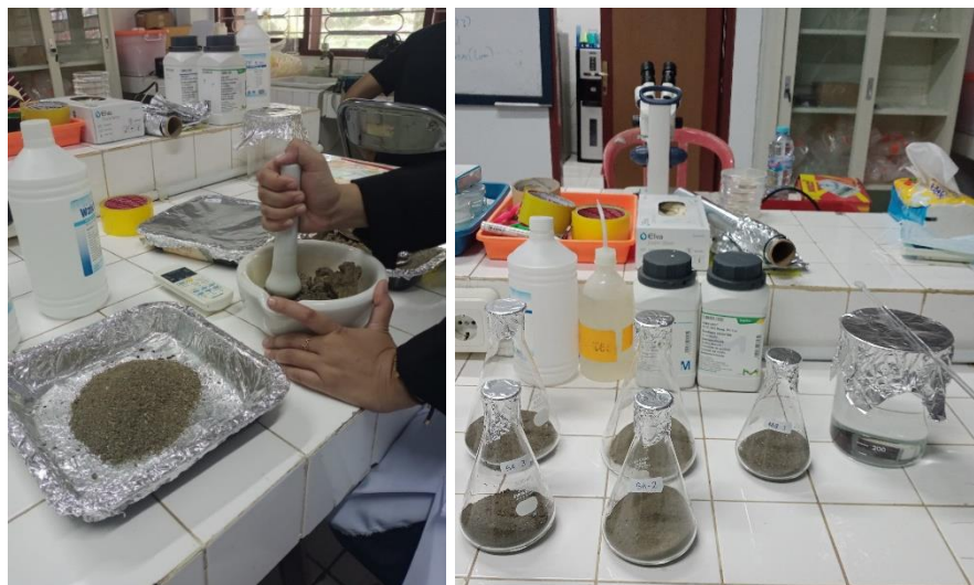
Proses penghalusan dan penimbangan sampel sedimen kering
