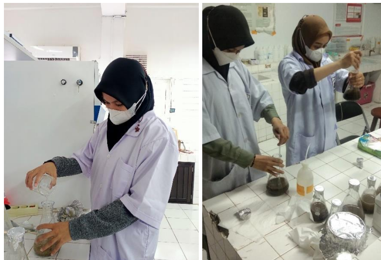
Proses pencampuran dan pengadukan larutan NaCl dengan sampel sedimen
