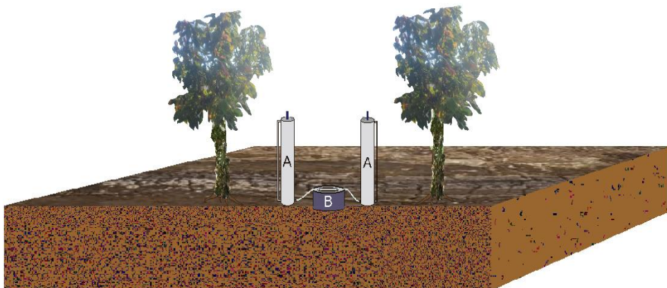
Gambar 4. Ilustrasi skematik penempatan pipa marriott (A) dan double ring infiltrometer (B)
