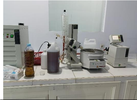
Memisahkan Ekstrak Dan Pelarut Menggunakan Evaporator
