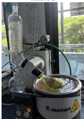
Gambar 6. Proses penguapan pelarut ekstrak menggunakan rotavapor
