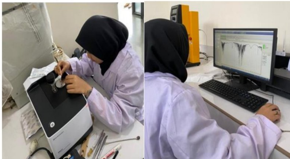
Gambar 20. Proses Analisis Jenis Polimer Mikroplastik menggunakan alat Fourier Transform Infrared (FTIR)
