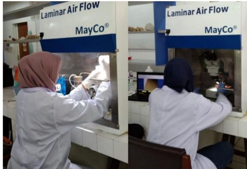
Gambar 19. Proses Penyaringan/filtrasi sampel dan pengamatan karakteristik serta perhitungan jumlah mikroplastik pada tiap sampel
