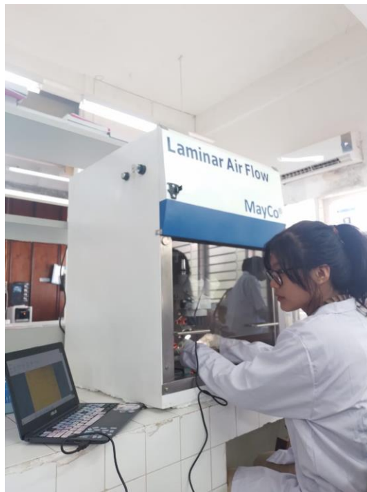
f. Proses pengamatan partikel mikroplastik menggunakan laminar air flow
