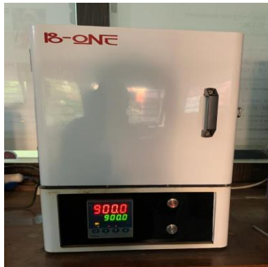
kalsinasi \text{CaCO}_3 selama 4 jam dengan suhu 900^\circ\text{C}
