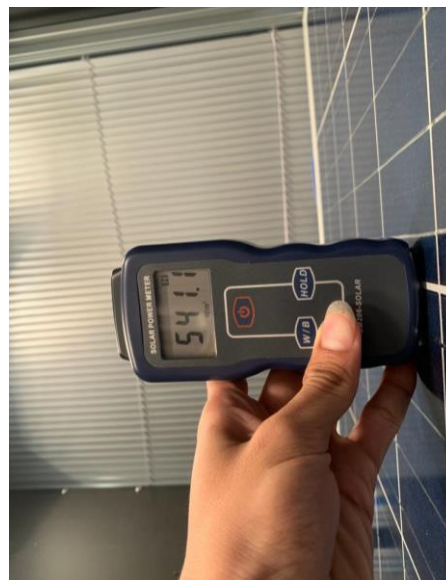
Proses Pengambilan Data Intensitas Cahaya dengan Solar Cell
