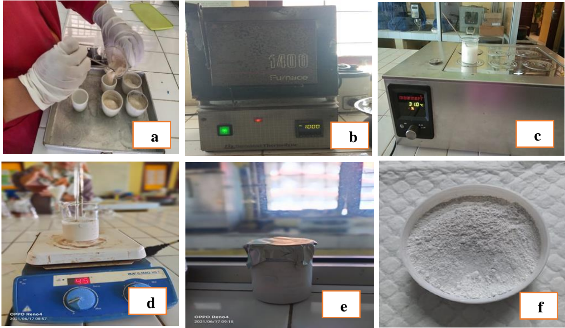
Gambar 12: Proses pembuatan Hidroksiapatit cangkang kepiting rajungan. a; serbuk cangkang kepiting ditimbang sebanyak 8 g dan disimpan dalam wadah tanur. b; dikalsinasi dengan suhu 1000^{\circ}\text{C} selama 5 jam. c; mereaksikan prekursor kalsium dan prekursor fosfat. d; ditambahkan NaOH 2 M hingga pH 10. e; suspensi didiamkan pada suhu kamar selama 24 jam untuk menumbuhkan kristal hidroksiapatit. f; hidroksiapatit yang terbentuk kemudian diayak hingga halus.
