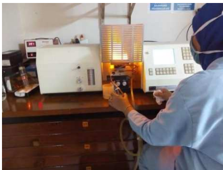
Sampel diukur menggunakan alat spektrofotometri serapan atom
