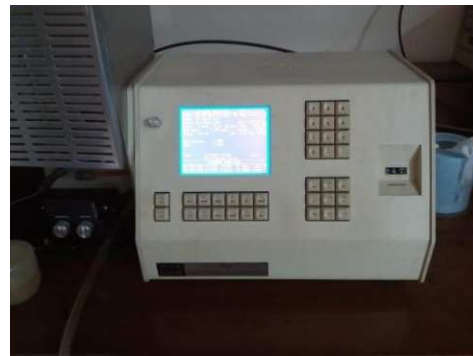
Sampel diukur menggunakan alat spektrofotometri serapan atom
