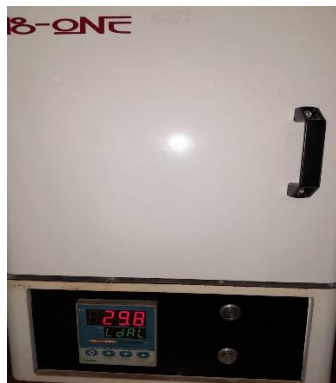
Sampel disintering pada suhu 700°C, 800°C dan 900°C
