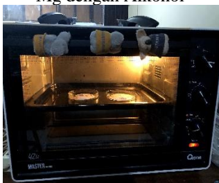
Dipanaskan pada suhu 80°C Selama 3 jam untuk menghilangkan Kadar alkohol pada sampel
