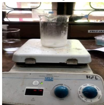
Di stirer selama 3 jam dengan suhu 80°C
