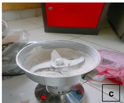
Gambar 1: Proses pembuatan serbuk cangkang kepiting rajungan. a; bahan baku limbah cangkang kepiting rajungan ( Portunus pelagicus ) dibersihkan. b; Cangkang kepiting rajungan dikeringkan dalam oven, c; Cangkang kepiting yang telah kering kemudian digrinder hingga halus, d; Bubuk cangkang kepiting yang telah di grinder kemudian diayak hingga ukuran 100MeSH
