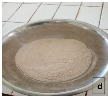
Gambar 1: Proses pembuatan serbuk cangkang kepiting rajungan. a; bahan baku limbah cangkang kepiting rajungan ( Portunus pelagicus ) dibersihkan. b; Cangkang kepiting rajungan dikeringkan dalam oven, c; Cangkang kepiting yang telah kering kemudian digrinder hingga halus, d; Bubuk cangkang kepiting yang telah di grinder kemudian diayak hingga ukuran 100MeSH
