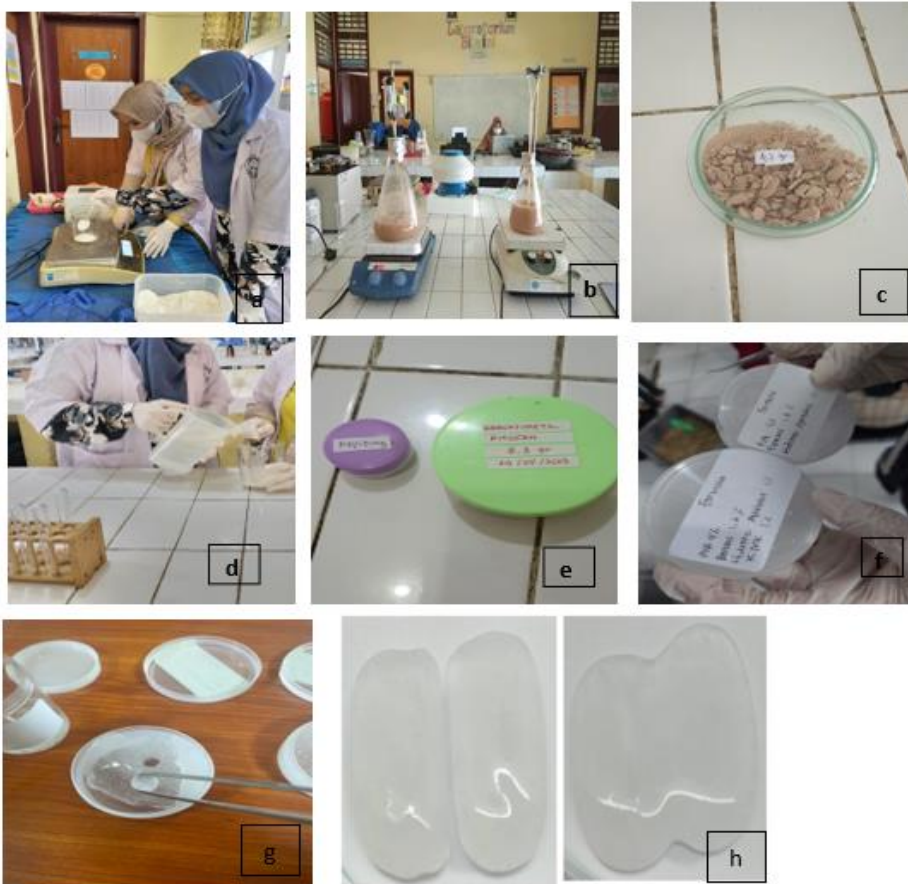
Gambar 2: Proses pembuatan hidrogel kitosan dari cangkang Kepiting Rajungan. a. Cangkang dibersihkan dan dihaluskan kemudian diayak menggunakan ayakan. Serbuk cangkang 200g diekstraksi kitin melalui proses deproteinasi menggunakan NaOH 0,3M dengan perbandingan 1:15 (b/v) selama 1 jam pada suhu 80°C. b. Hasil deproteinasi kemudian disaring dan dicuci menggunakan akuades dan dikeringkan, lalu dilanjutkan proses demineralisasi menggunakan HCl 0,55 M dengan perbandingan 1:10 (b/v) selama 1 jam. c. Hasil demineralisasi disaring dan residu dicuci dengan akuades hingga pH netral lalu dikeringkan. d. proses deasetilase, kitin yang dihasilkan diproses kembali untuk dijadikan kitosan. e. bubuk HA dan bubuk karboksimetil kitosan; f. Siapkan Carboxymethyl chitosan 4% yang sudah dilarutkan dengan aquades dan PEMA 8% yang juga dilarutkan dengan a quades; g. hidrogel kitosan + HA cangkang Kepiting Rajungan h. Foto pembesaran hidrogel kitosan +HA
