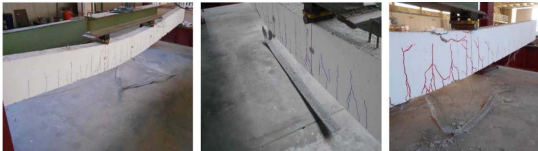
Gambar 5. Kegagalan benda uji balok SRG
