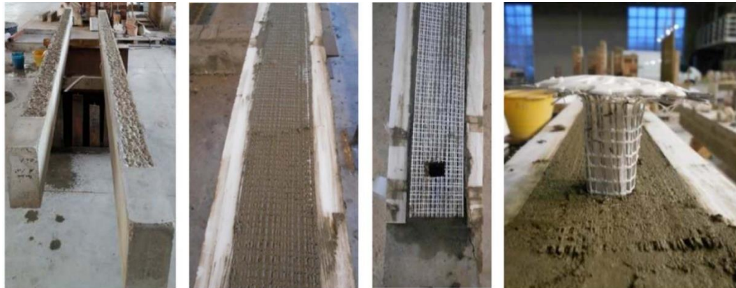
Gambar 4. Persiapan benda uji balok SRG
