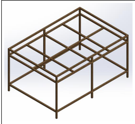
Gambar 19. Desain Rangka Alat Pengering.
