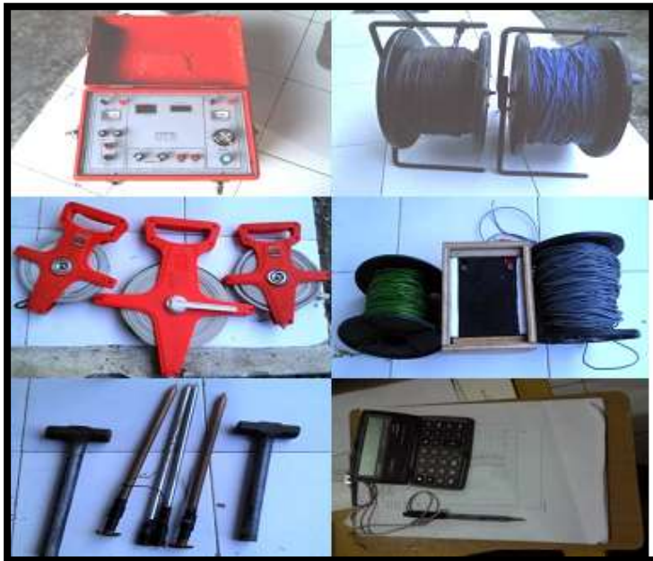
Gambar 5. Foto Peralatan Geolistrik Naniura NRD 300 HF
